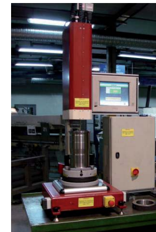
Rys. 1. Urządzenie do pomiaru średnicy i odchyłki kształtu tulei cylindrowych
