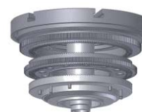
Rys. 1. Przyrząd podziałowy do dyskretnego pozycjonowania urządzeń obrotowych (zgłoszenie patentowe P 386679 z dnia 4.12.2008 r.)
