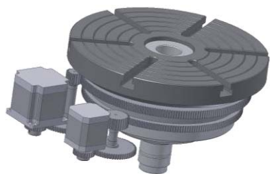
Rys. 3. Napęd pierścieni nastawczych przez silniki krokowe
