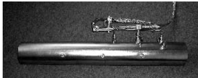
Rys. 3. Widok analizatora spalin (a) i sondy do pomiaru masowego natężenia przepływu spalin (b)
