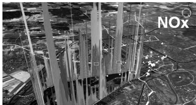
Rys. 6. Rozkład chwilowej emisji tlenków azotu podczas przejazdu wytyczoną trasą dla dwóch rodzajów paliw zasilających pojazd.
