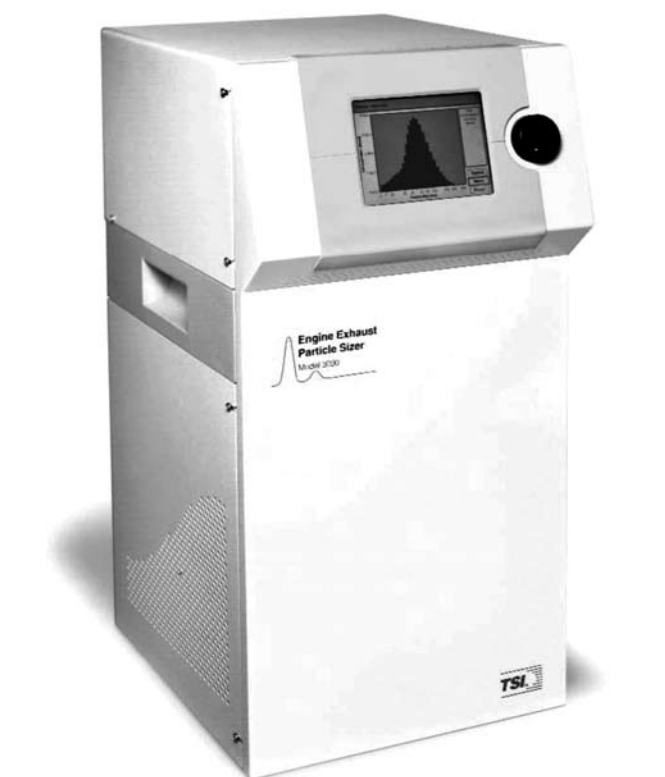
Rys. 10. Engine Exhaust Particle Sizer – spektrometr masowy do pomiaru rozkładu cząstek stałych
