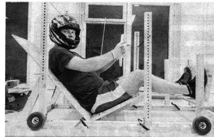
► Członkowie zespołu PUT Motorsport zbudowali już niezbędną do dalszych prac makietę ergonomii stanowiska kierowcy oraz uruchomili testowo silnik, który będzie napędzał ich bolid
