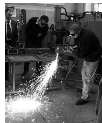
Pokaz cięcia strumieniem tlenu z zachowaniem dużej odległości źródła ciepła od podłoża
